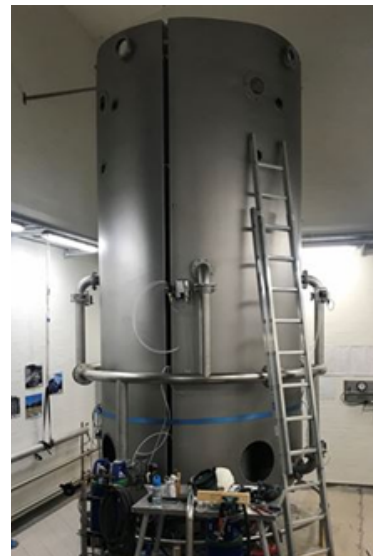
Figur 3.11 Princip af PAS anlæg og billede af forsøgsanlæg på ca. 10 - 15 m 3 /time.
